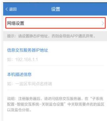
2、**服务器设置**：网络设置完成后返回设置页面，输入信息交互服务器IP以及本机描述信息，输入完成后点击保存即可。
